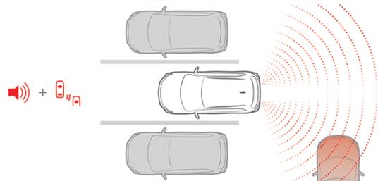
Détecte un véhicule s'approchant d'un côté ou de l'autre lorsque vous êtes en marche arrière. Le système vous alerte par des témoins clignotants dans les deux rétroviseurs extérieurs, une tonalité dans l'habitacle et un message d'avertissement au tableau de bord.
