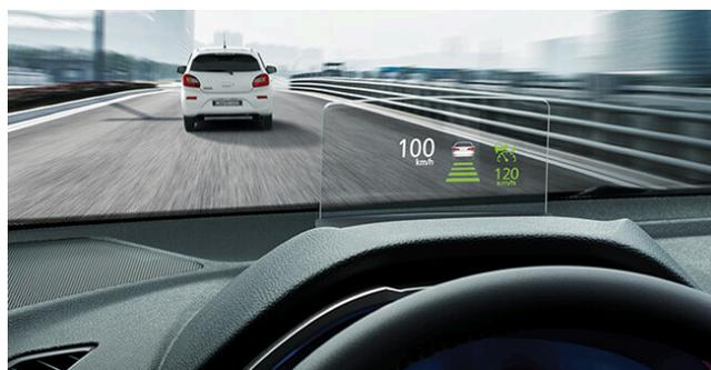
Commodément situé sur le haut de la planche de bord, dans votre ligne de visée directe, l'affichage tête haute livrable projette votre vitesse et d'autres informations pertinentes sur la sécurité et le véhicule, telles que les données relatives à l'atténuation de collision avant et au régulateur de vitesse adaptatif, afin que vous puissiez garder les yeux sur la route devant vous.
