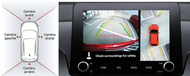
Série de caméras créant une vue à vol d'oiseau des environs et une vue grand angle offrant plus de commodité et de sécurité en marche arrière et lors des stationnements en parallèle.
