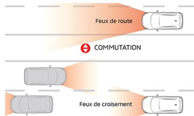
Détectent les niveaux de lumière des phares des véhicules en sens inverse et font passer les phares automatiquement entre les feux de croisement et les feux de route, une caractéristique de sécurité utile lors de la conduite sur des routes faiblement éclairées.
