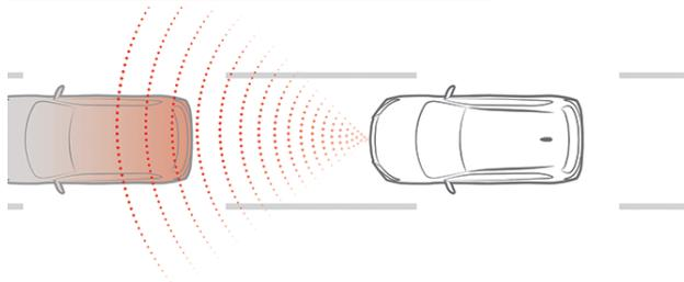
Utilise le radar pour ajuster automatiquement la vitesse de croisière du véhicule et maintenir une distance fixe entre vous et le véhicule devant.
